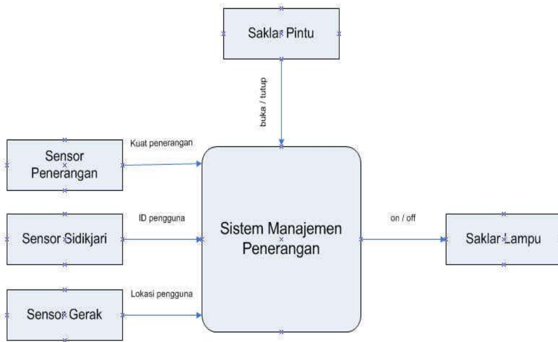
Gambar 3. Diagram konteks sistem manajemen penerangan
